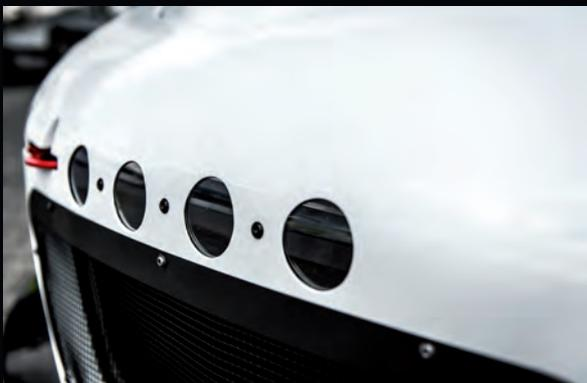
Zusatzbeleuchtung 24h (Nightface). Zusätzliche, in die vordere Stoßstange integrierte Scheinwerfer garantieren eine bessere Sicht in der Dunkelheit.
