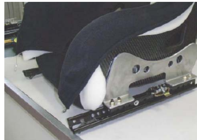
Sitzadapter wie bisher (hier nur unlackiert); Befestigungslöcher für Sitzbefestigung um max. 30 mm nach unten verlegt (mit Genehmigung OMP); zwischen Sitzschale und Adapter Distanz- scheiben von ca. 5 mm Dicke
